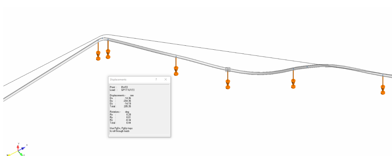
Рисунок 8 – Картина просадки в районе ПК24а+09 с применением теплоизоляции 50мм
